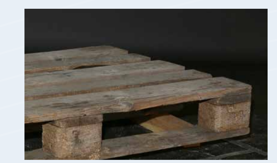
Keine vorgeschriebene Kennzeichnung mehr lesbar
