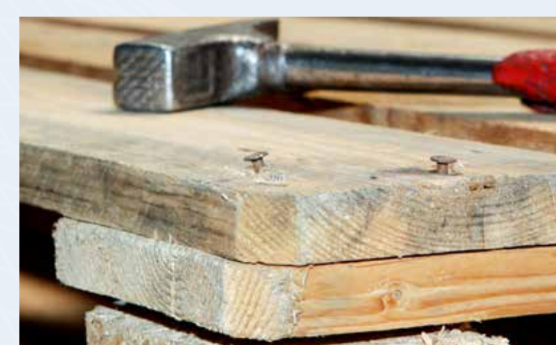
Einschlagen herausstehender Befestigungselemente
